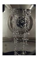
**Abb. 1**: Freistrahl von flüssigem Blei-Bismut
